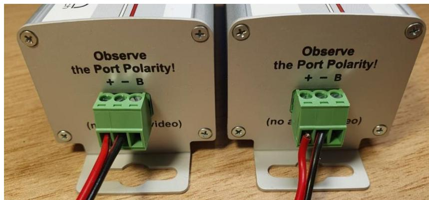
Si usa el puerto B para la función "Boost", esto significa que en caso de que use el tercer cable para aumentar la transmisión de datos hasta 1000 Mbps, asegúrese de no cruzar los cables con los puertos + o -. Vea la imagen a continuación.
